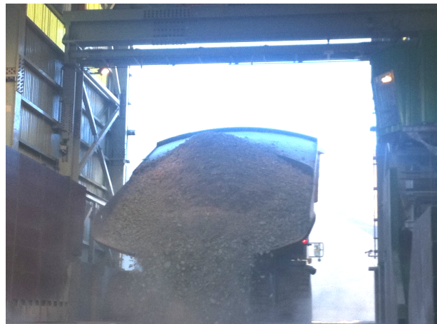
一次クラッシャー投入の様子
