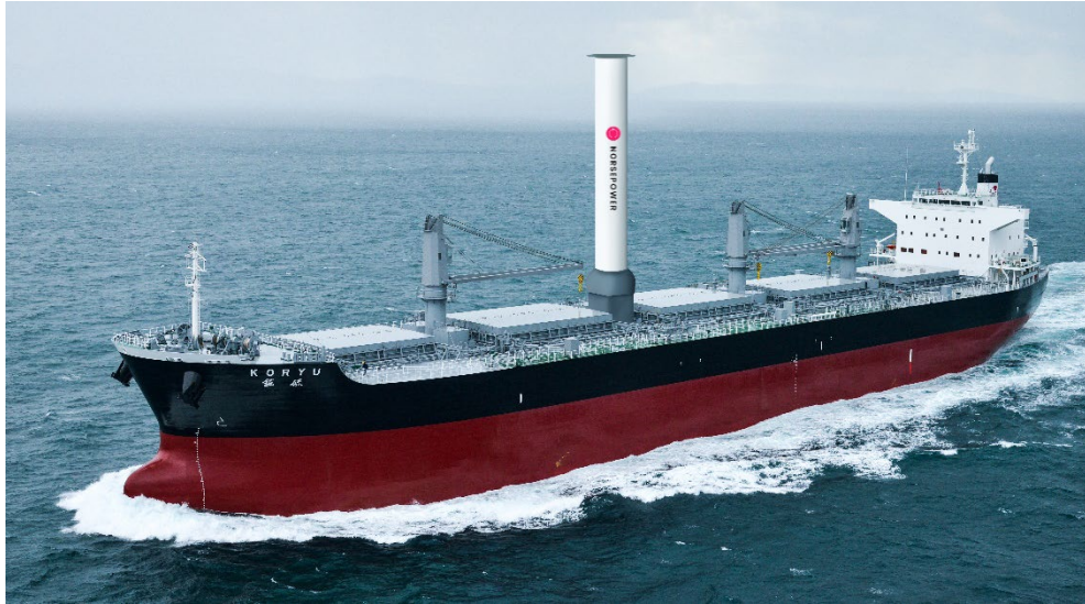
ノースパワーのローターセイルを KORYU 号に搭載したイメージ写真。本船クレーンを取り外し、起倒式のローターセイルを取り付ける計画。
