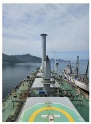
高さ35m、直径5mのローターセイルは、港での荷役作業が容易になるように傾斜できる設計になっています。
